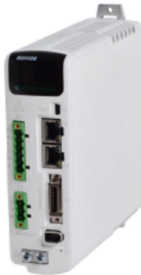
高创伺服系统调试方法：接线。将控制卡断电，连接控制卡与伺服之间的信号线。以下的线是必须要接的：控制卡的模拟量输出线、使能信号线、伺服输出的编码器信号线。复查接线没有错误后，电机和控制卡（以及PC）上电。此时电机应该不动，而且可以用外力轻松转动，如果不是这样，检查使能信号的设置与接线。确认给出正数，电机正转，编码器计数增加；给出负数，电机反转，编码器计数减小。用外力转动电机，检查控制卡是否可以正确检测到电机位置的变化，否则检查编码器信号的接线和设置。高创伺服系统在执行伺服控制时，无须编码器也可实现速度、位置、扭矩等的控制。中空伺服电机订做商家
